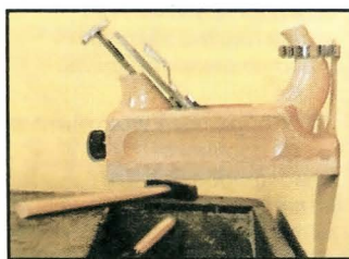
Стальные скобы для подвески рубанков крепят к стене шурупами с дюбелями. Рубанок вставляется снизу.
