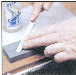
Доводка тыльной поверхности лезвия круговыми движениями по камню.
