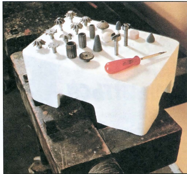
Деталь упаковки из твердого пенопласта. В проделанные в ней отверстия вставляют хвостовики фрезы и другие инструменты.
