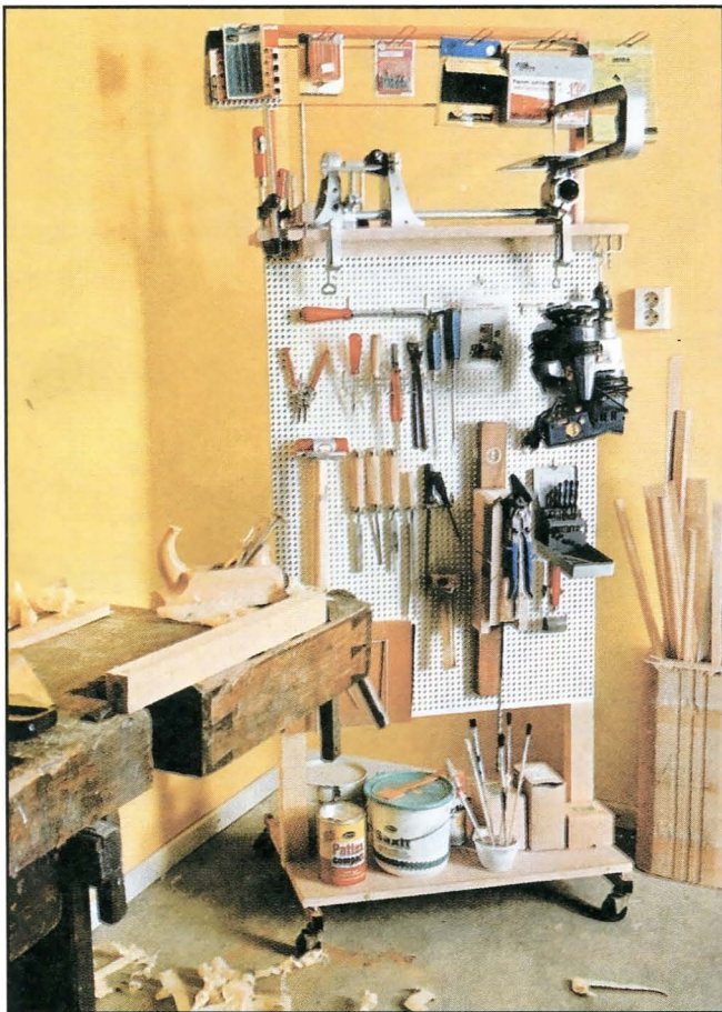
На отслужившую свой срок тележку из универмага установлено дно из столярной плиты. Перфорированная твердая ДВП с крючками из проволоки служит вешалкой для инструментов.
