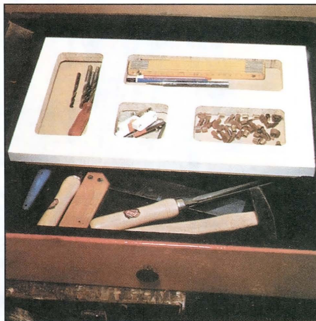
Выдвижной ящик в качестве хранилища для инструментов. В него вклеивают планки из твердой древесины, вкладывают кассетницу из ДСП толщиной 24 мм, снизу которой прикреплено шурупами фанерное дно.
