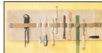
Резиновый шнур, используемый для крепления багажа к велосипеду, прибивают к доске, а поверх него к доске привинчивают шурупами металлические полоски длиной 30 мм. В «кармашки» между полосками вставляют инструменты.
