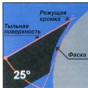
Необходимо соблюдать угол 25^\circ между тыльной поверхностью и фаской.
