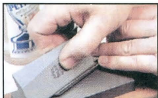
Доводка тыльной поверхности лезвия круговыми движениями по камню.
