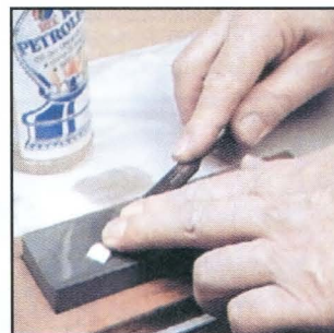
Доводка тыльной поверхности лезвия круговыми движениями по камню.
